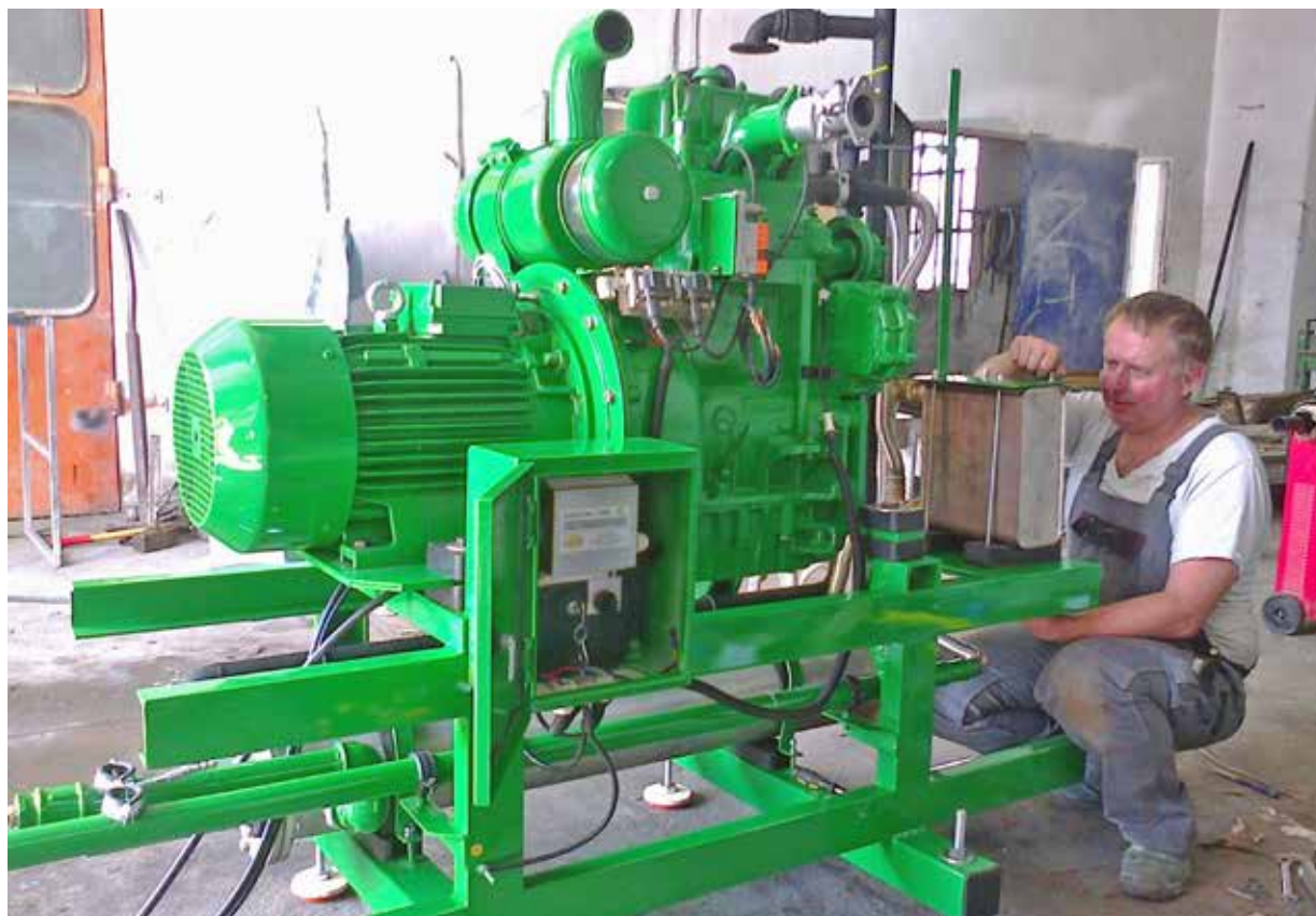
Rys. 7. Kogenerator o mocy 10 kW (silnik Perkinsa i prądnica Celma Cieszyn)
