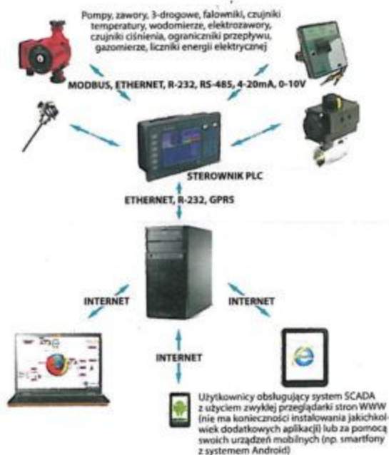
Rys. 3. Uproszczony schemat budowy Systemu Zarządzania Energią
